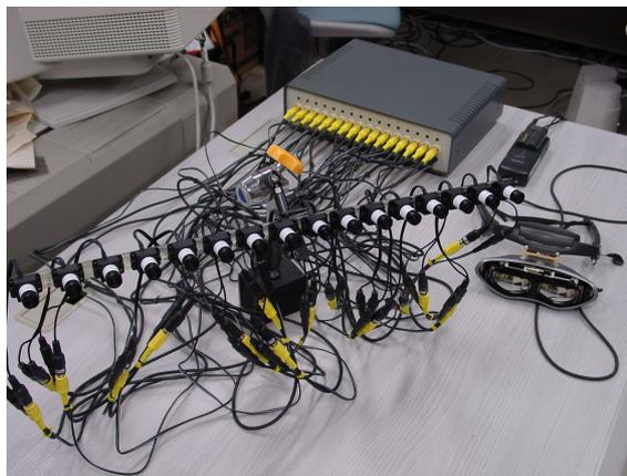
写真1 マルチプレクサによる視覚の移動感覚提示システム
